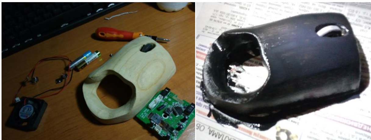
Рис. 2. Изготовление корпуса макета мыши
