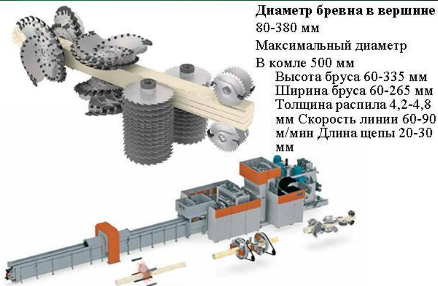
Рисунок - профилирующий круглопильный двухшпиндельный агрегат немецкой компании SAB.
